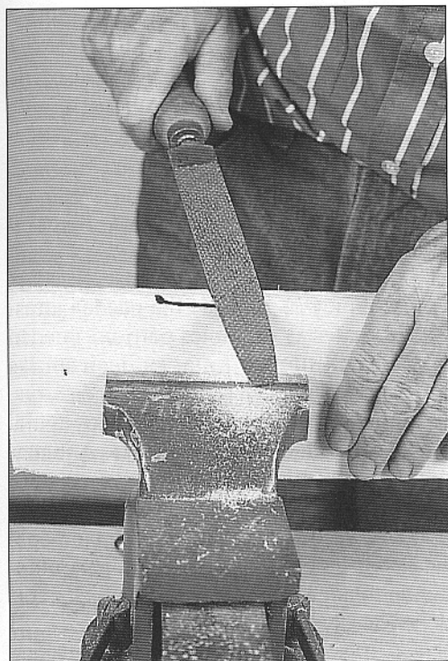
La escofina manual permite realizar a gran velocidad los rebajes de las bisagras
