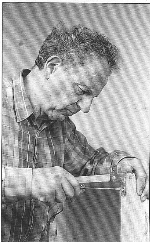
Uniremos los paneles con clavijas pasantes y tornillos
