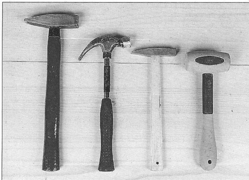
Los cuatro tipos de martillos más utilizados por los carpinteros. El último de la derecha es un mazo de goma que no estropea la madera
