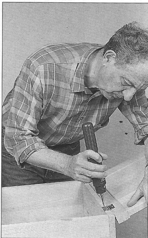
La operación más delicada es la fijación de las bisagras
