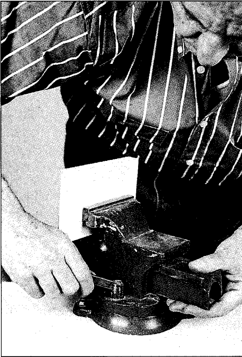
Este modelo de mordaza puede girar para trabajar en la posición más cómoda. La parte plana superior puede servir de yunque
