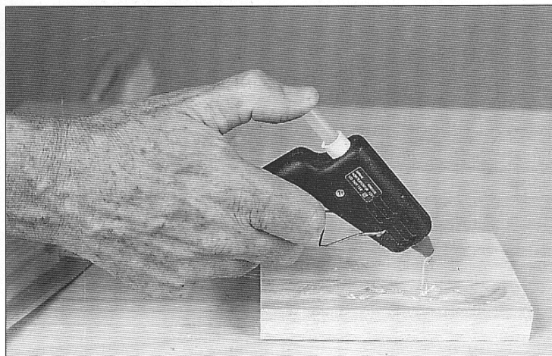
La pistola hot-melt deposita una tira muy delgada de adhesivo termofusible que se pega en pocos segundos
